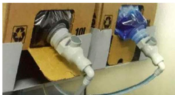
Consigue la dosis exacta de producto de la forma más cómoda y segura, conectando la bolsa de 10L con la bomba dosificadora mediante la **conexión rápida**. El sistema utiliza un soporte para cada producto.
