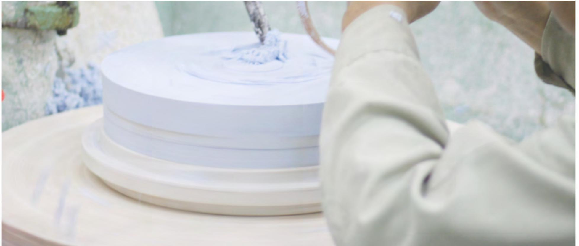
Comienza con la combinación correcta de materias primas: arcilla fina y sedosa molida, tamizada, desmagnetizada y filtrada según nuestros exigentes estándares por nuestro equipo de técnicos experimentados. La base de arcilla tiene forma de moldes de yeso en 3D diseñados por artesanos y luego colocados en un horno automatizado para el proceso inicial de horneado de galletas a una temperatura de 800 grados centígrados.
