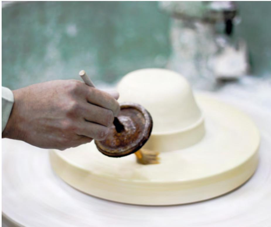
Las piezas están pintadas a mano según las especificaciones del diseño o esmaltadas para lograr el efecto preciso requerido, ya sea transparencia, opacidad o un efecto semi-mate. Luego, los artículos vidriados se hornean por segunda vez a una temperatura de 1250 a 1300 grados centígrados para producir un acabado perfecto. Si se requieren decoraciones de calcomanías, se aplican y las piezas se cuecen una tercera vez.
