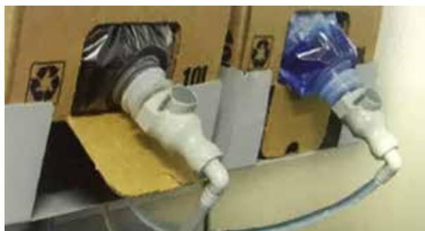
Consigue la dosis exacta de producto de las forma más cómoda y segura, conectando la bolsa de 10L con la bomba dosificadora mediante la **conexión rápida**. El sistema utiliza un soporte para cada producto.
